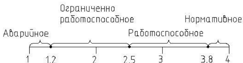
Рис.5. Шкала ранжирования категорий технического состояния несущих конструкций
